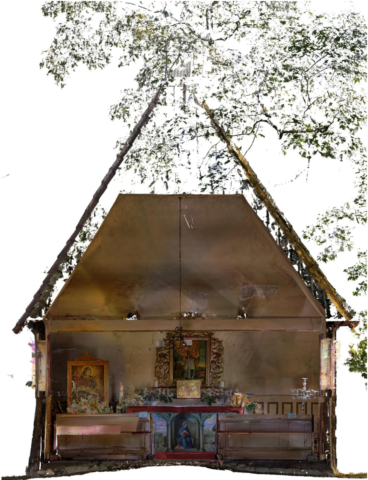
Ortofotoplan 6 Rzut wnętrza z widokiem na ścianę północną.
